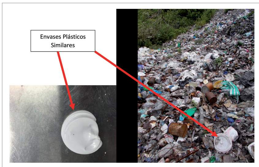
Figura 12. Dos envases plásticos similares, el de la izquierda fue sometido a 2 \text{ kW/m}^2 por 30 segundos en el laboratorio de la Universidad de Queensland (20 de julio, 2015), el de la derecha corresponde a una imagen obtenida el 23 de Julio del 2015 en el basurero municipal de Cocula. Este ensayo no intenta reproducir los materiales del basurero municipal de Cocula sino simplemente ilustrar cambios típicos inducidos por calor a envases plásticos.
