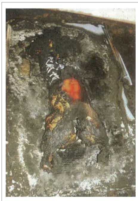
Figura 6. Residuos de la cremación de un cerdo (deHaan y Icove, 2012). Cuando el cuerpo se incinera en función a sus propias grasas deja, después de más de 6 horas de quemado, aproximadamente el 50% de su masa como residuo.
